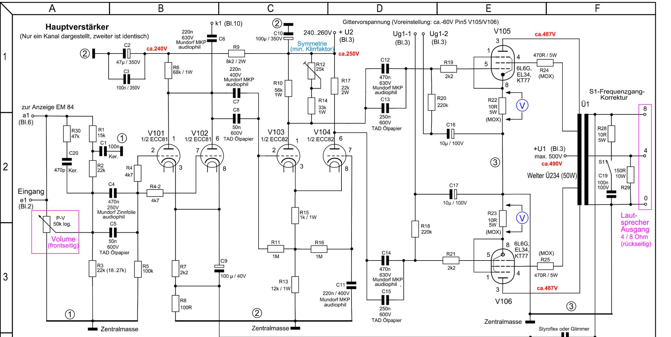
① Masse Eingangsschaltung    ② Masse Vorstufe    ③ Masse Endstufe     $V$  ca.400 mV ( = 40 mA Ruhestrom bei 6L6G; auf die verwendeten Endröhren abstimmen!)
